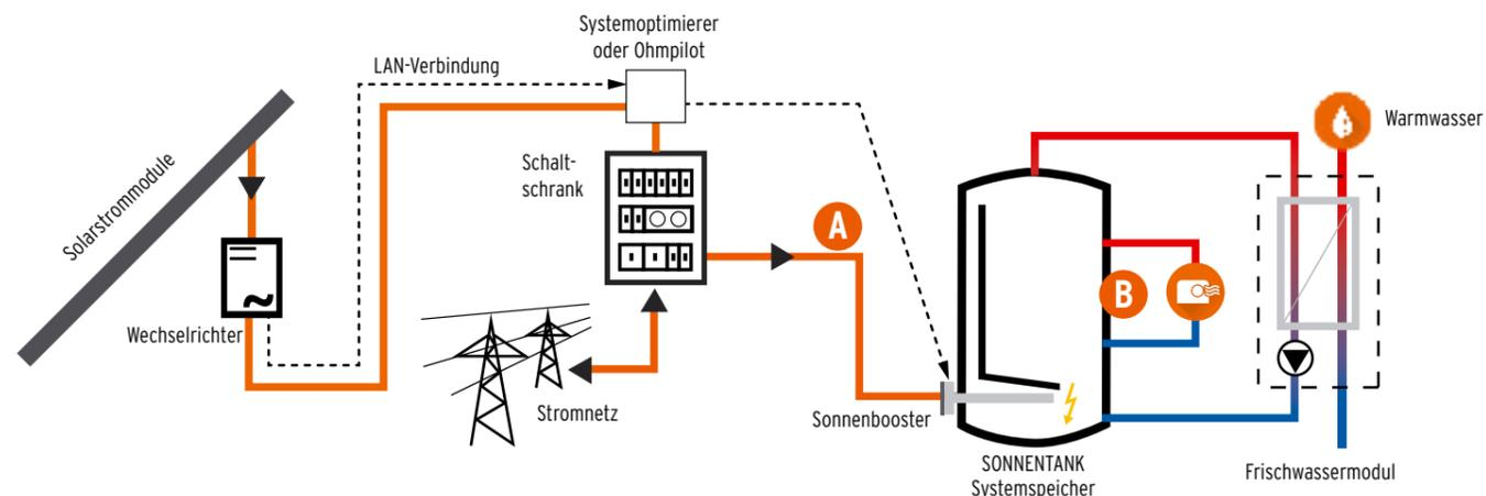
**A** Bei Solarstrom-Überschuss bringt der Energiemanager SOB0050 die überschüssige Energie stufenweise (1 - 7) in den SONNENBOOSTER und erhitzt somit den Speicherinhalt. Jede Stufe wird mit 750 W geschaltet.
